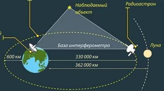
«Радиоастрон» работает совместно с международной сетью наземных радиотелескопов, образуя гигантский наземно-космический телескоп (интерферометр) высочайшего углового разрешения.
